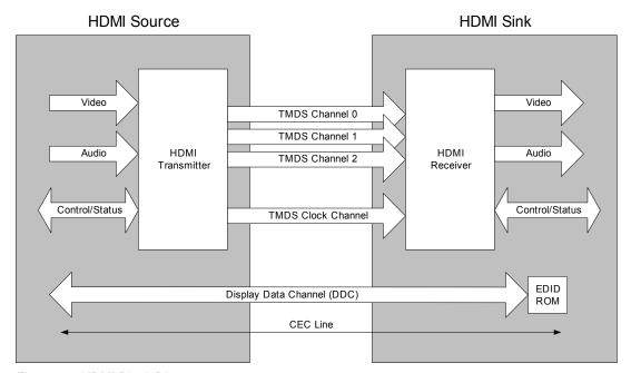
Figure 3-1 HDMI Block Diagram
