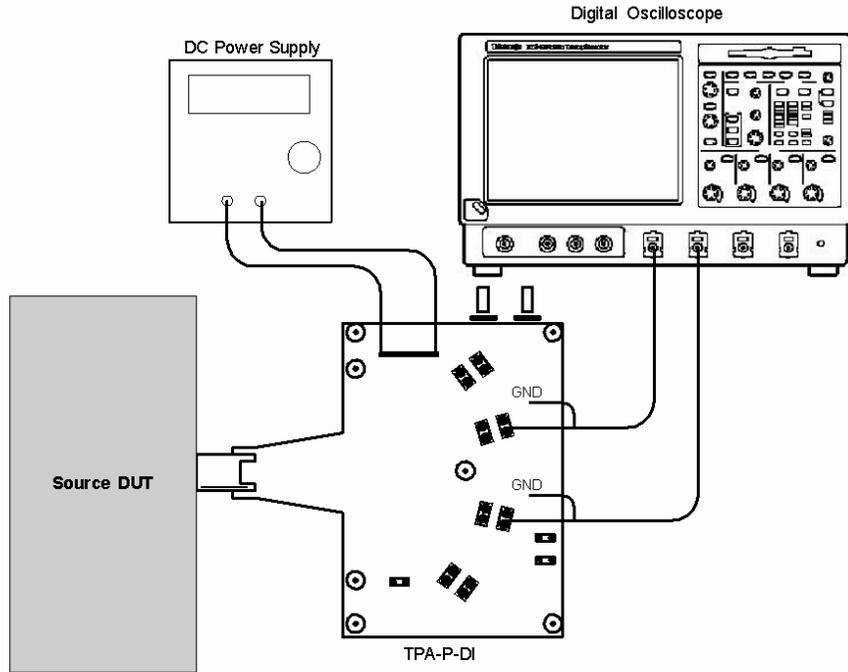
Setup 19. Test ID 7-6: TMD5 – Inter-Pair Skew – Tektronix TDS7404
