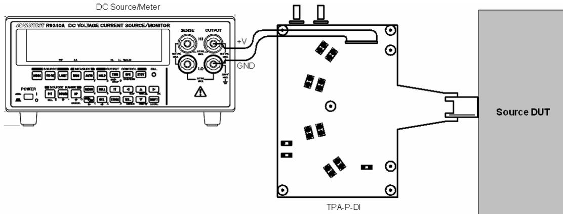
Setup 34. Test ID 7-11: +5V Power
